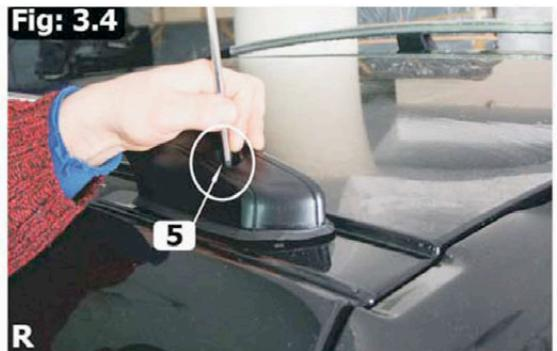
**SCHRITT 5** Nach der fertigen Montage die Dichtungskappen aufsetzen.
