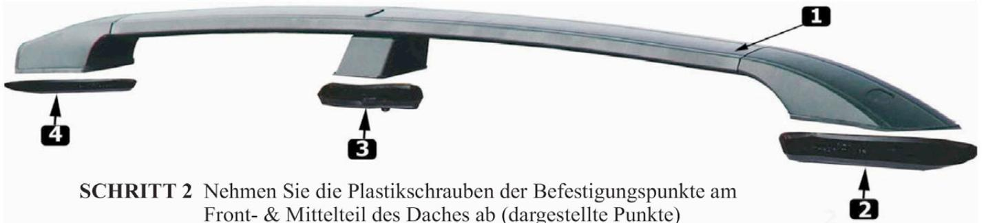
**SCHRITT 2** Nehmen Sie die Plastikschraben der Befestigungspunkte am Front- & Mittelteil des Daches ab (dargestellte Punkte)
