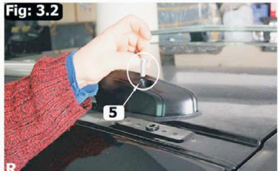
**SCHRITT 4** Schrauben Sie die Dachreling mit den mitgelieferten Schrauben an den vorhandene Befestigungspunkten fest.
