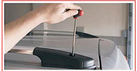
**SCHRITT 4** Schließen Sie die Schraubenvertiefungen nach der fertigen Montage, mit den Dichtungskappen zu.
