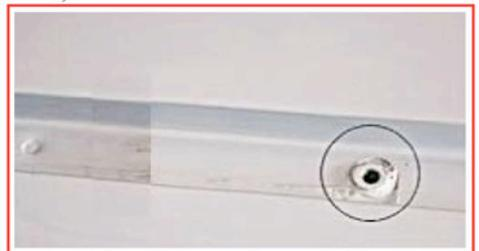
**SCHRITT 2** Setzen Sie die Dachreling mit den Gummimatten auf das Dach ihres Fahrzeugs.
