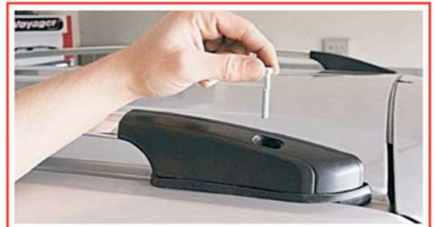
**SCHRITT 3** Schrauben Sie die Dachreling mit den mitgelieferten Schrauben an den vorhandene Befestigungspunkten fest.
