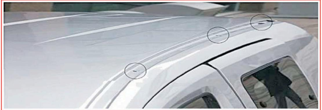
**SCHRITT 1** Nehmen Sie die Plastik schrauben der Befestigungspunkte an der Front & Mittelteil und Hinten des Daches ab (dargestellte Punkte)
