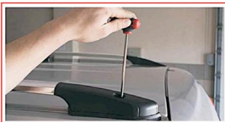
**SCHRITT 4** Schließen Sie die Schraubenvertiefungen nach der fertigen Montage, mit den Dichtungskappen zu.
