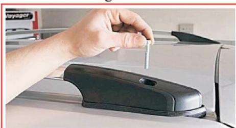
**SCHRITT 3** Schrauben Sie die Dachreling mit den mitgelieferten Schrauben an den vorhandene Befestigungspunkten fest.
