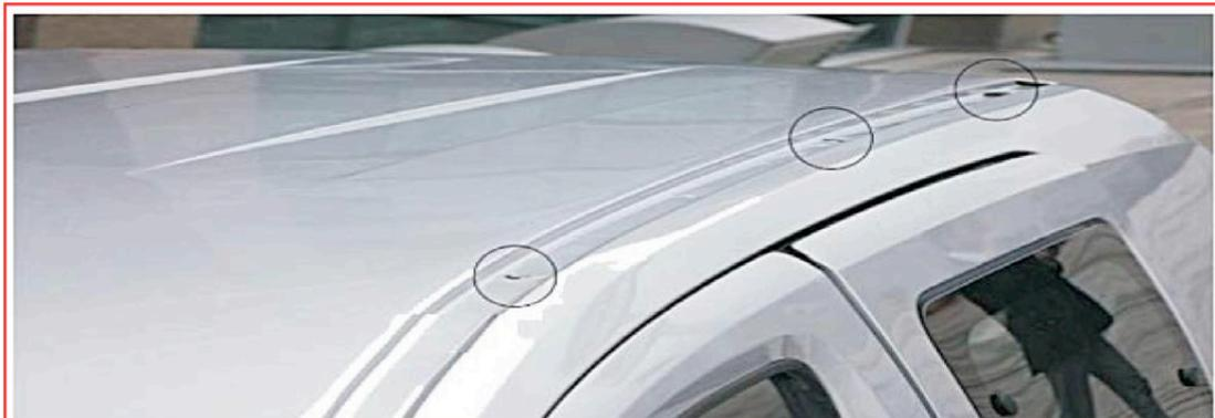
**SCHRITT 1** Nehmen Sie die Plastikschrauben der Befestigungspunkte an der Front & Mittelteil und Hinten des Daches ab (dargestellte Punkte)
