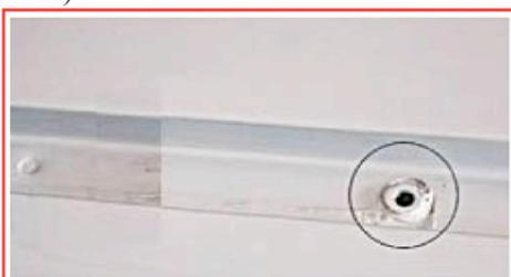
**SCHRITT 2** Setzen Sie die Dachreling mit den Gummimatten auf das Dach ihres Fahrzeugs.
