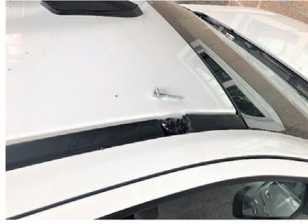
11) Nach der Nietmontage werden die Nietpunkte großzügig mit Silikon gefüllt. (vorne)
