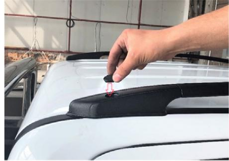
15) Setzen Sie die Gummistopfen wie im Bild dargestellt ein. (hinten)
