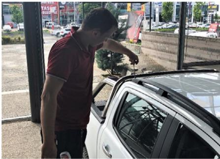
13) Nachdem die Befestigungspunkte mit Silikon gefüllt sind, wird die Dachreling am Fahrzeug fest geschraubt (hinten)
