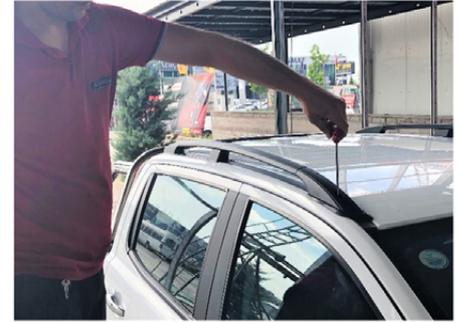
12) Nachdem die Befestigungspunkte mit Silikon gefüllt sind, wird die Dachreling am Fahrzeug fest geschraubt (vorne)
