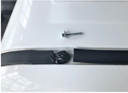
10) Nach der Nietmontage werden die Nietpunkte großzügig mit Silikon gefüllt. (hinten)
