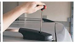
SCHRITT 5 Schließen Sie die Schraubenvertiefungen nach der fertigen Montage, mit den Dichtungskappen zu.
