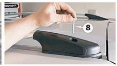
**SCHRITT 4** Schrauben Sie die Dachreling mit den mitgelieferten Schrauben an den vorhandene Befestigungspunkten fest.
