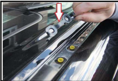
3) Entfernen Sie die Metallklammern
