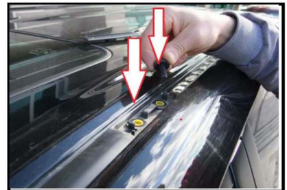
2) Lösen Sie alle 6 Schrauben
