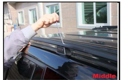
8) Drehen Sie alle Schrauben fest
