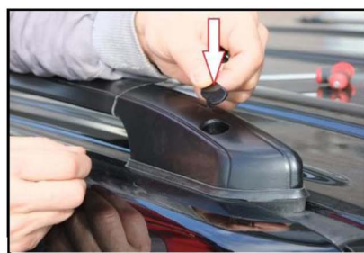
10) Setzen Sie alle Abdeckkappen auf
