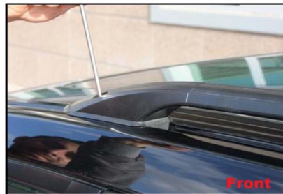
7) Setzen Sie die Dachrelinge mit den Gummimatten auf das Dach ihres Fahrzeugs
