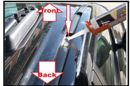
5) Fügen Sie in die Schraubenlöcher ca. einen Tropfen Silikon (Für die Wasserdichtigkeit)
