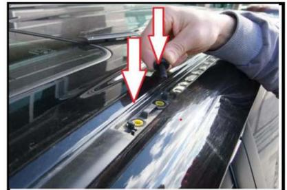
2) Lösen Sie alle 6 Schrauben
