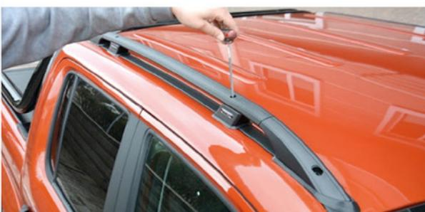
9) Nun nach der Reihenfolge die Schrauben einschrauben (max. 8,5 newton) oder mit der Hand festziehen.
