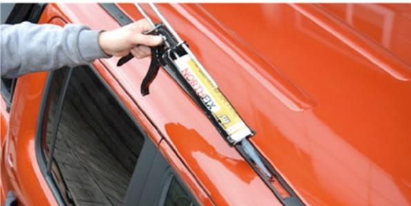
3) Benutzen Sie das gelieferte Silikon um die Löcher vor dem verschrauben etwas zu füllen.
