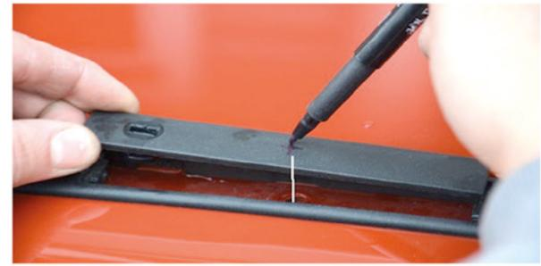
4) Markieren Sie an der Plastikkappe die Bohrungsstelle, damit die M65 Schraube durchgeht. Benutzen Sie dafür erst den kleinen 3mm Bohrer dannach den 8mm Bohrer.
