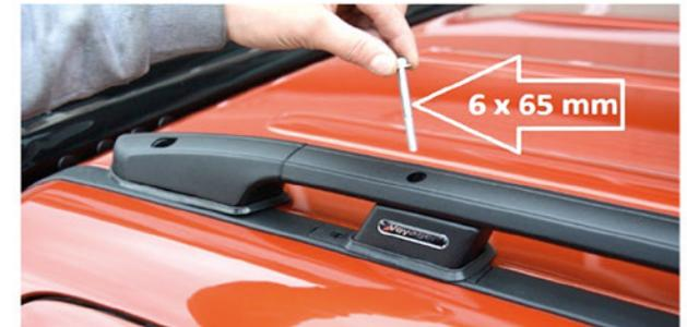
8) Setzen Sie wie im Bild die M65 Schrauben ein.
