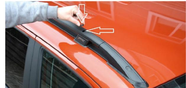
10) Als letztes die Plastikkappen wieder aufsetzen. Die maximale Traglast der Dachrelinge beträgt 75 Kg.
