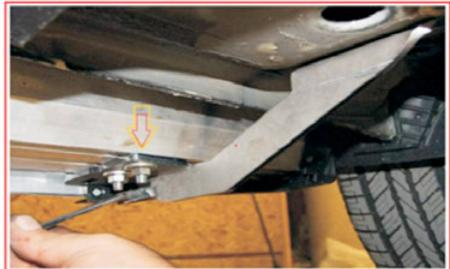
Um die vordere Halterung zu befestigen müssen Sie vorher die Abdeckung entfernen. (S. Bild 1)
