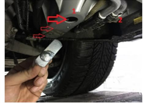
3) Setzen Sie als nächstes die M12 Spezialschrauben in das erste Loch ein.
