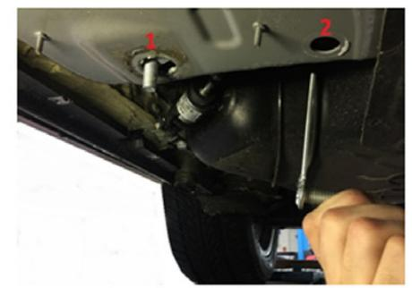
9) Den selben Schritt wiederholen Sie im zweiten Loch mit der M10 Spezialschraube.
