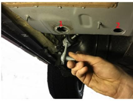
8) Setzen Sie in das erste Loch die M12 Spezialschraube ein.
