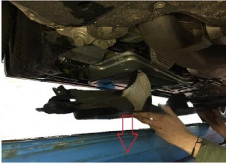
1) Bauen Sie als erstes die Schmutzverkleidung unterhalb des Fahrzeugs ab.
