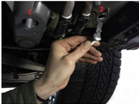
4) Setzen Sie anschließend in das zweite Loch die M10 Spezialschraube ein.
