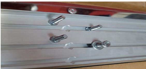
Als erstes schrauben Sie die M8 Schrauben unter die Trittbretter, bewahren Sie aber die M8 Muttern für die spätere Verschraubung auf.
