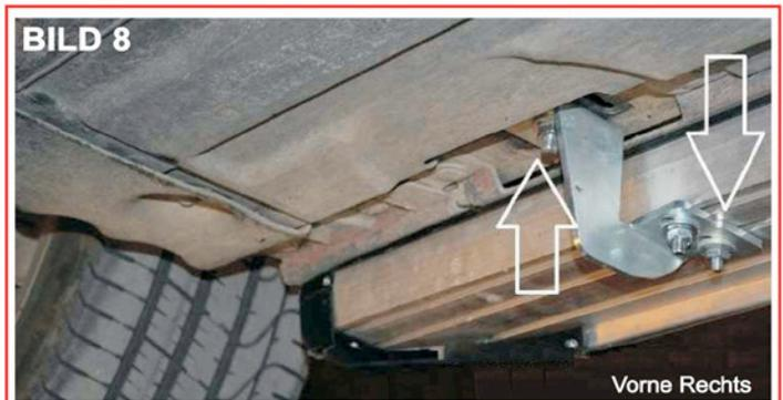
Die Halterung wird am Fahrzeug in die auf Bild 7 und Bild 8 dargestellte Position eingesetzt und verschraubt.
