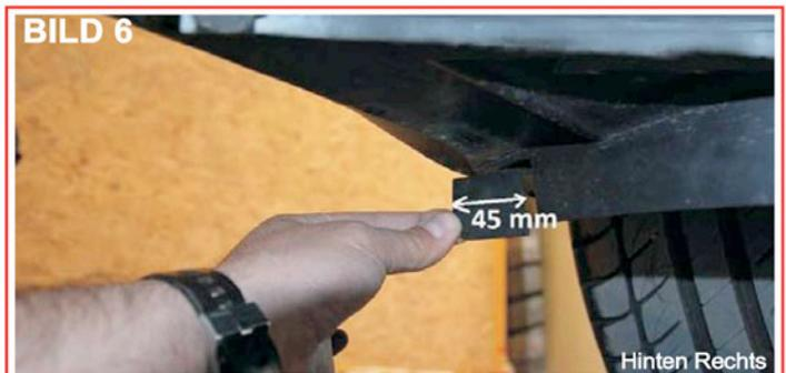
für hinten rechts wie auf dem Bild 6 dargestellt 45mm von dem Schmutzfänger abschneiden.
