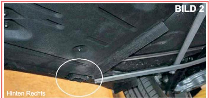
Um die Halterung zu befestigen müssen Sie vorher die Abdeckung entfernen. (S. Bild 1 und Bild 2)
