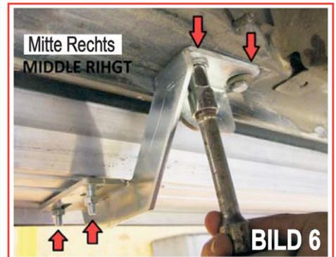
Die Halterungen mit den mitgelieferten Schrauben Nr. 7 am Fahrzeug wie auf Bild 4, Bild 5 und Bild 6 dargestellte Position ansetzen und anschrauben. Bitte beachten Sie, dass die Schrauben noch nicht fest angezogen werden, da noch die genaue Ausrichtung erfolgen muss.
