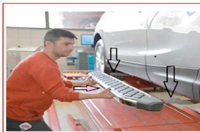
Packen Sie die Trittbretter bitte erst nach BILD 9 auf die Halterungen und verschrauben Sie alle Schrauben am Fahrzeug.
