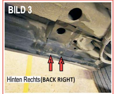
Die Befestigungspunkte sind bereits am Fahrzeug vorhanden siehe Bild 1, Bild 2 und Bild 3. Für die vordere Befestigung benutzen Sie die Halterung Nr.1 und Nr.4. Für die mittlere Befestigung benutzen Sie die Halterung Nr.2 und Nr.5. Für die hintere Befestigung benutzen Sie die Halterung Nr.3 und Nr.6. Bitte beachten Sie, dass die Schrauben noch nicht fest angezogen werden, da noch die genaue Ausrichtung erfolgen muss.
