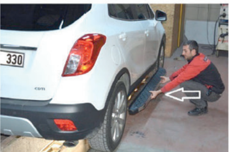
12) Als letztes setzen Sie die Trittbretter auf die Halterungen und justieren Sie diese genau, danach verschrauben Sie die Muttern fest.
