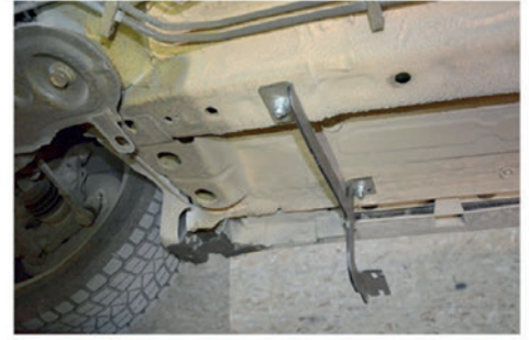
5) Bringen Sie nun die Halterung an und befestigen Sie diese mit den Muttern.
