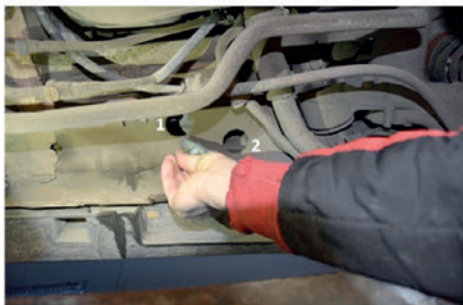
7) Setzen Sie hier in die gekennzeichneten Stellen die Spezialschrauben in T-Form ein.
