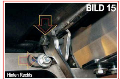
Die Spezialklammerhalterungen (Nr.8) werden an der Positionen auf dem Bild 13 und Bild 14 befestigt und ausgerichtet.
