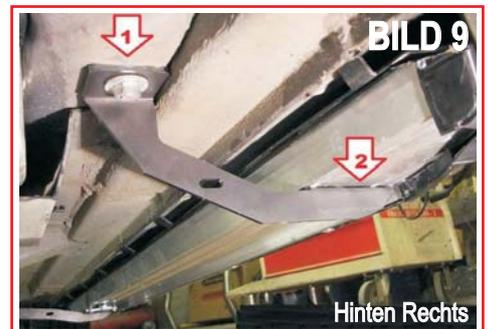
Der Befestigungspunkt für hinten rechts wird auf dem Bild 7 dargestellt. Die spezial Schraube mit der Nr.5 wird am Fahrzeug in die auf Bild 8 dargestellte Position eingesetzt. Die Schraube mit der Nr.5 wie auf Bild 9 dargestellt einsetzen und wie auf Bild 7 dargestellt verschrauben. Für hinten benutzen Sie die Halterung mit der Nr. 3 und 4.
