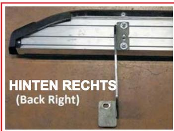
Als Erstes die Halterungen an die Trittleisten montieren. Die Schrauben so weit anziehen, dass man die Trittbretter noch genau ausrichten kann.
