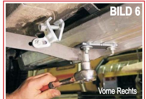
Der Befestigungspunkt für vorne rechts wird auf dem Bild 1 dargestellt. Die spezial Schraube mit der Nr.5 wird am Fahrzeug in die auf Bild 2 dargestellte Position eingesetzt. Die Schraube mit der Nr.5 wie auf Bild 3 dargestellt einsetzen und wie auf Bild 4 dargestellt verschrauben. Für vorne benutzen Sie die Halterung mit der Nr. 1 und 2.
