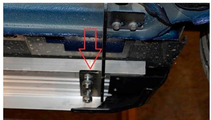
6) Die hintere Halterung wie im Bild dargestellt montieren, setzen Sie die gelieferte Schraube im Punkt 1 ein. Nun können Sie die vorher gelösten Schrauben im Punkt 2 dargestellt wieder einschrauben.
