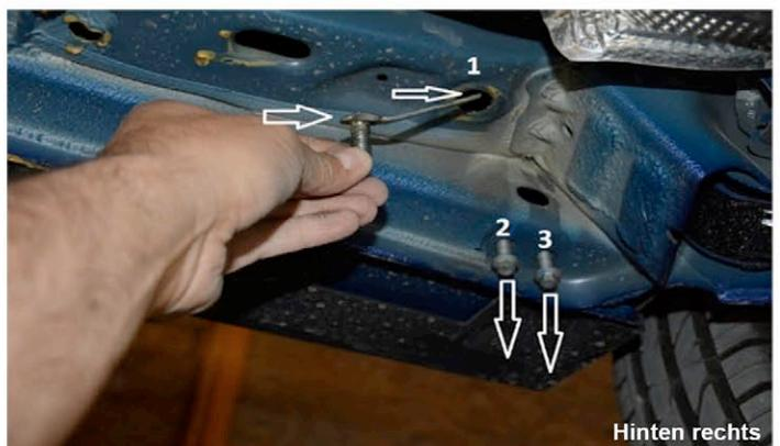
4) Führen Sie die Montage wie oben im Bild durch, bringen Sie wie auf dem Pfeil 1. dargestellt die Schraube aus dem Lieferumfang an. Anschließend können Sie die im Schritt 3) gelöste Schraube nun um die Halterung zu befestigen wieder anschrauben.
