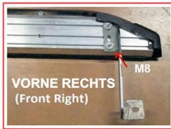
1) Als Erstes die Halterungen an die Trittleisten montieren. Die Schrauben so weit anziehen, dass man die Trittbretter noch genau ausrichten kann.
