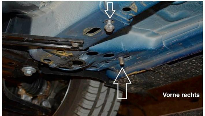
2) Die im Lieferumfang erhaltene, kleinere Spezialschraube wie im Bild dargestellt einsetzen.
