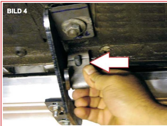
Der Befestigungspunkt für hinten rechts wird auf dem Bild 3 dargestellt. Die spezial Schraube mit der Nr.5 wird am Fahrzeug in die auf Bild 3 dargestellte Position eingesetzt. Die Halterung Nr.3 wie im Bild 4 dargestellt anschrauben. Für die hintere Befestigung benutzen Sie die Halterung Nr.3 und Nr. 4. Bitte beachten Sie, dass die Schrauben noch nicht fest angezogen werden, da noch die genaue Ausrichtung erfolgen muss.
