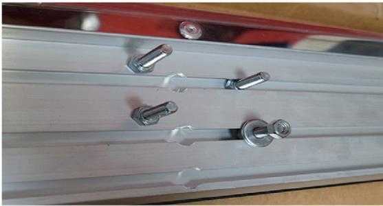
1) Als erstes schrauben Sie die M8 Schrauben unter die Trittbretter, bewahren Sie aber die M8 Muttern für die spätere Verschraubung auf.
