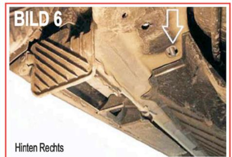
Der Befestigungspunkt für hinten rechts wird auf dem Bild 4 dargestellt. Die Schraube mit der Nr.5 wird am Fahrzeug in die auf Bild 5 und Bild 6 dargestellte Position eingesetzt. Für die hintere Befestigung benutzen Sie die Halterung Nr.3 und Nr.4.
