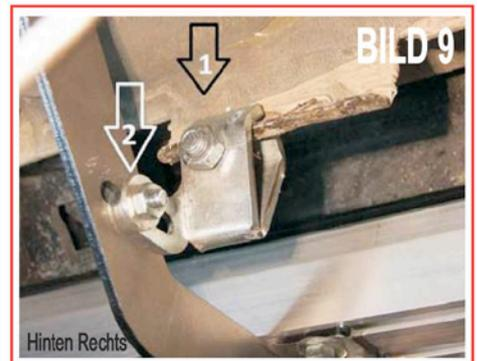
Die Halterung für vorne rechts wird wie auf Bild 7 dargestellt angeschraubt. Anschließend wird für die hintere Halterung, die Spezialklammerhalterung mit der der Nr.6 wie auf Bild 8 und Bild 9 dargestellt angeschraubt. Diese Klammerhalterung verhindert ein absackung des Trittbretter.
