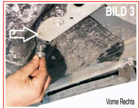
Der Befestigungspunkt für vorne rechts wird auf dem Bild 1 dargestellt. Die Schrauben an den dargestellten punkte entfernen. Die Halterung mit den zuvor entfernten schrauben am Fahrzeug in die auf Bild 2 und Bild 3 dargestellte Position eingesetzt und verschrauben. Für die vordere Befestigung benutzen Sie die Halterung Nr.1 und Nr.2.
