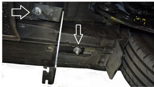
4) Bringen Sie als nächstes die Halterungen für die hinteren Seiten wie im Bild dargestellt an. (Bild hinten rechts)
