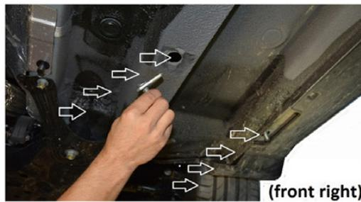
7) Platzieren nun die L-Schrauben in die Löcher (Vorne am Fahrzeug)
