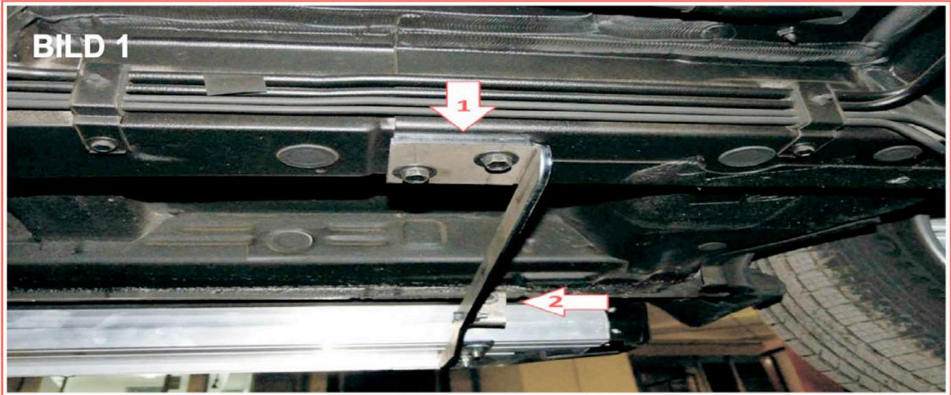
Den Halter für vorne links und rechts, an die bereits am Fahrzeug vorhandene Gewinde Bohrungen mit Nummer 1 (S. Bild 1) mit den mitgelieferten Schrauben befestigen.
