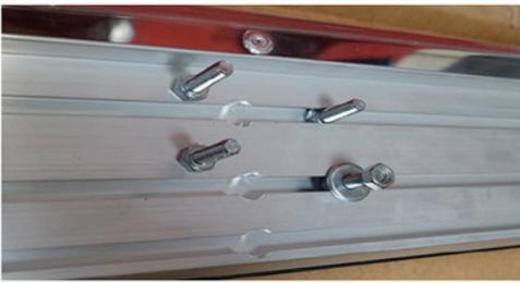
Als erstes schrauben Sie die M8 Schrauben unter die Trittbretter, bewahren Sie aber die M8 Muttern für die spätere Verschraubung auf.
