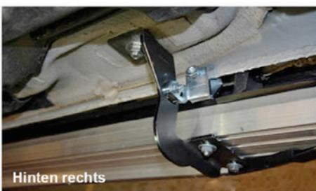
11) Justieren Sie nun die spezielle Klammer auch an der Karosserie und schrauben Sie diese fest.
