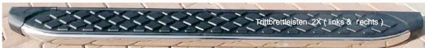
Unter der Trittbrettleiste befinden sich die Befestigungsschrauben M8 Schrauben (8x), M 8 Muttern (8x) und Unterlegscheiben (8x)
