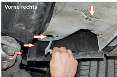
5) Nun die spezielle Schraube in L - Form (12 mm) wie im Bild einsetzen.
