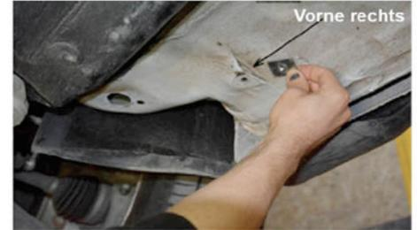
4) Wie im Bild die spezielle viereckige M8 Unterlegmutter anbringen.
