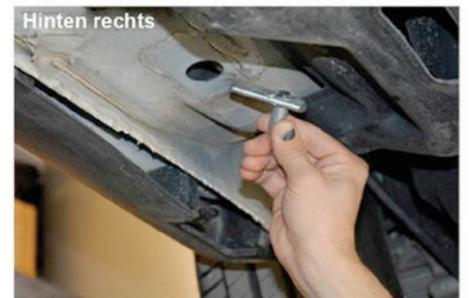
7) Setzen Sie nun auch hinten die spezielle Schraube in L-Form (12 mm) ein.
