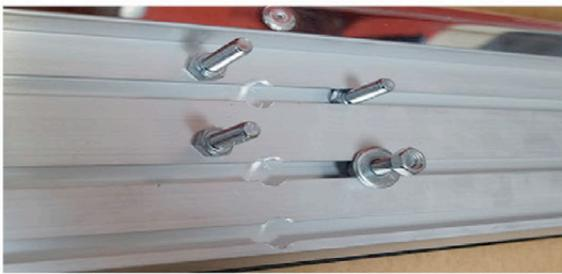
Als erstes schrauben Sie die M8 Schrauben unter die Trittbretter, bewahren Sie aber die M8 Muttern für die spätere Verschraubung auf.
