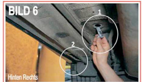
Der Befestigungspunkt für hinten rechts wird auf dem Bild 5 dargestellt. Die Plastikabdeckung an den dargestellten punkte entfernen. Die Schraube mit der Nr.5 wird am Fahrzeug in die auf Bild 6 dargestellte Position eingesetzt. Die Schraube mit der Nr.6 wird am Fahrzeug in die auf Bild 7 dargestellte Position eingesetzt.
