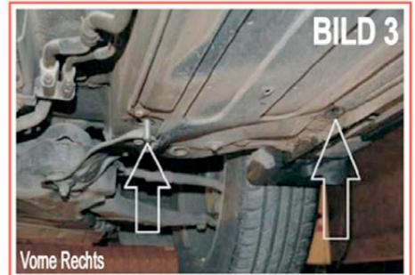
Der Befestigungspunkt für vorne links wird auf dem Bild 1 dargestellt. Die Plastikabdeckung an den dargestellten punkte entfernen. Der Befestigungspunkt für vorne rechts wird auf dem Bild 2 dargestellt. Die Plastikabdeckung an den dargestellten punkte entfernen. Die Schraube mit der Nr.5 wird am Fahrzeug in die auf Bild 3 dargestellte Position eingesetzt. Die Halterung wie auf Bild 4 dargestellt verschrauben. Für die vordere Befestigung benutzen Sie die Halterung Nr.1 und Nr.2.
