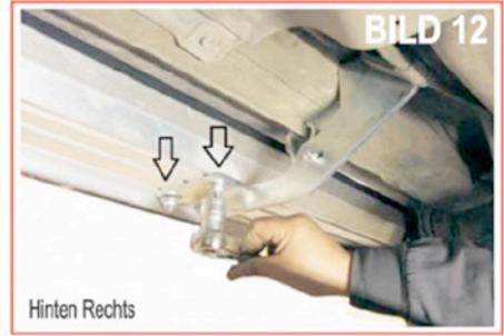
Der Befestigungspunkte für hinten rechts wird auf dem Bild 1 dargestellt. Die Plastikkappe wie auf dem Bild 7 dargestellt entfernen. Die Spezialschraube mit der Nr.5 wird am Fahrzeug in die auf Bild 8 und Bild 9 dargestellte Position eingesetzt. Die Halterung Nr.4 wie im Bild 10 dargestellt anschrauben. Für die hintere Befestigung benutzen Sie die Halterung Nr.3, Nr.4. Bitte beachten Sie, dass die Schrauben noch nicht fest angezogen werden, da noch die genaue Ausrichtung erfolgen muss.
