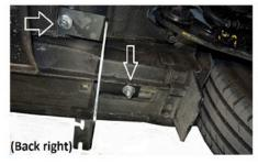
5) Bringen Sie nun die Halterung an und verschrauben Sie diese mit den Muttern.
