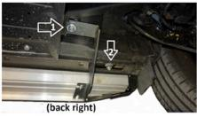
11) Nun können Sie die M8 Schrauben befestigen aber justieren Sie die Trittbretter genau bevor Sie diese festschrauben.
