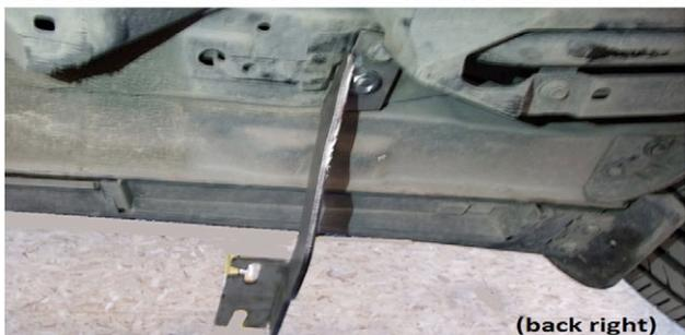
7) Montieren Sie nun hinten rechts am Fahrzeug die Halterung an.
