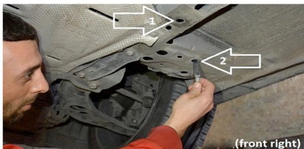
1) Auf dem Bild werden vorne rechts am Fahrzeug die Verschraubungspunkte mit den Pfeilen dargestellt.
