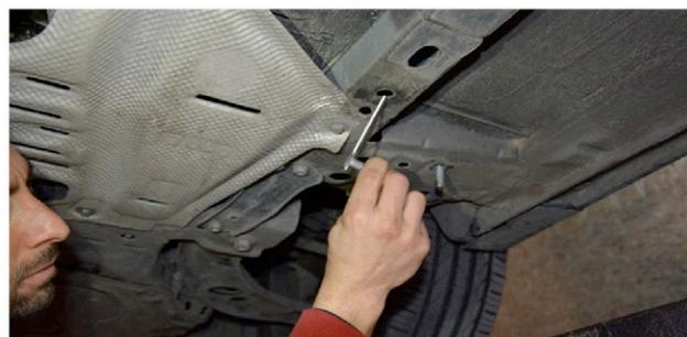
2) Setzen Sie hier die M10 Spezialschrauben ein.
