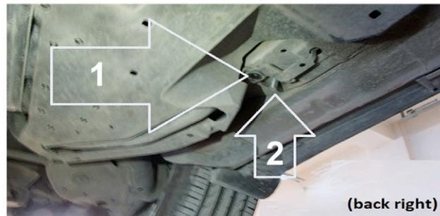
6) An der mit der 1. markierten Stelle ist eine Schraube die Sie abschrauben und aufbewahren müssen, die mit der 2. markierten Schraube können Sie abschrauben und die neue M12 Spezialschraube einsetzen.
