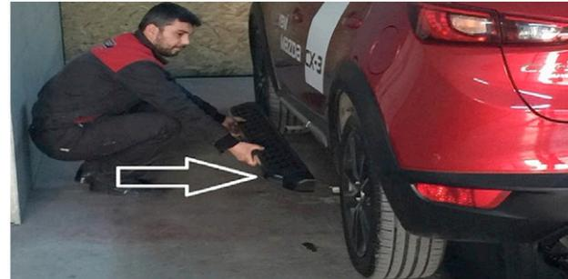
8) Zuletzt setzen Sie die Trittbretter an die Halterungen und schrauben Sie diese mit den M8 Schrauben nach der Justierung fest.
