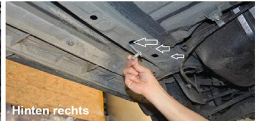
2) Bauen Sie hinten rechts den aus 2 Teilen bestehenden Unterschutzboden ab.
