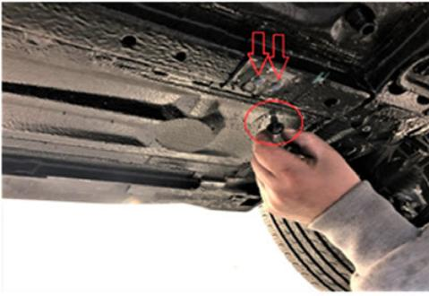
1) Entfernen Sie als erstes vorne unterhalb des Fahrzeugs die zwei dargestellten 8mm Schrauben.
