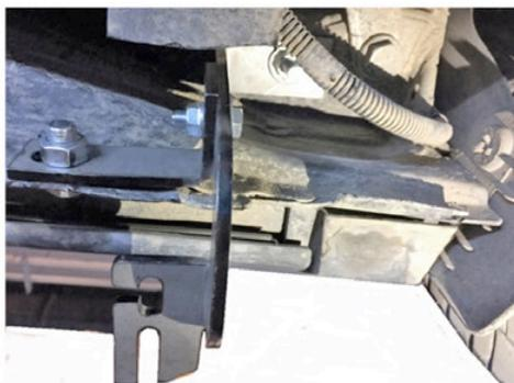
10) Nun können Sie als erstes die große Halterung hinten rechts verschrauben und anschließend die kleine Halterung an die große.
