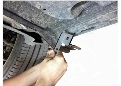
6) Montieren Sie als nächstes die kurze Halterung an die zuvor verschraubte große Halterung.
