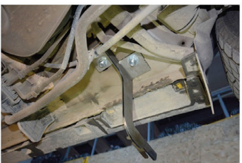
10) Befestigen Sie auch hier die Halterung mit den Muttern.
