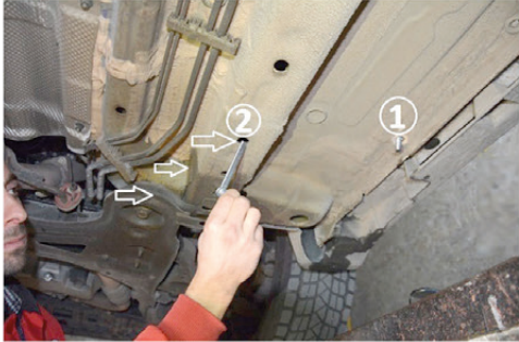
4) Als nächstes fügen Sie die Spezialschraube in L-Form in das Loch mit mit der Nummer 2.
