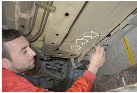
2) Fügen Sie dort die M12 Spezialschraube in L-Form ein.
