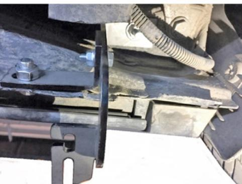
9) Schrauben Sie als nächstes die kleinen kurzen Halter hinten am Fahrzeug an.
