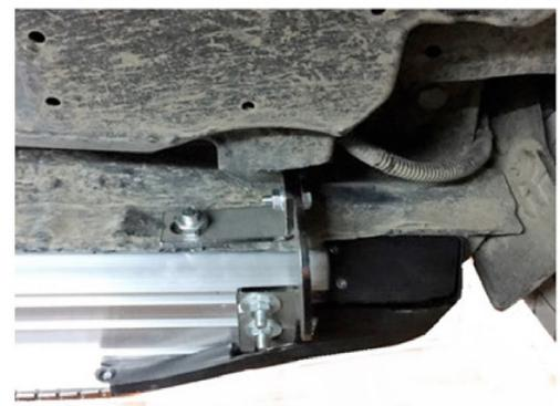
11) Nach der Justierung der Trittbretter schrauben Sie diese mit den M8 Schrauben fest.
