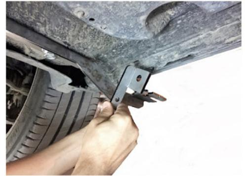
6) Verschrauben Sie nun die kurzen Halterwinkel mit den M12 Schraube am Fahrzeug.
