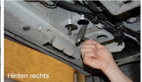
4) Setzen Sie hier die gelieferten Spezialschrauben ein in die markierten Punkte ein.
