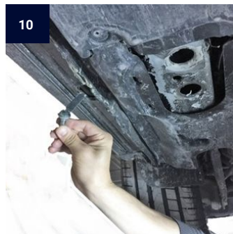
10 Setzen Sie die M10 L Schrauben ein Install the M10 L Screws
