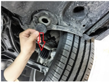
1) Entfernen Sie die Abdeckkappe.
