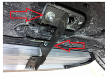
15) Wenn Sie das Trittbrett ausgerichtet haben, ziehen Sie alle Schrauben fest an.
