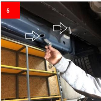
Setzen Sie an Punkt 2 die M12 L Schraube ein
