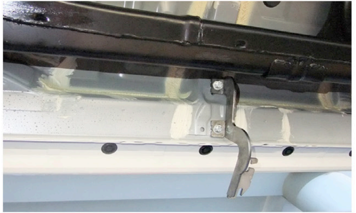
4) Verschrauben Sie hier die Halterung für die rechte Seite.
