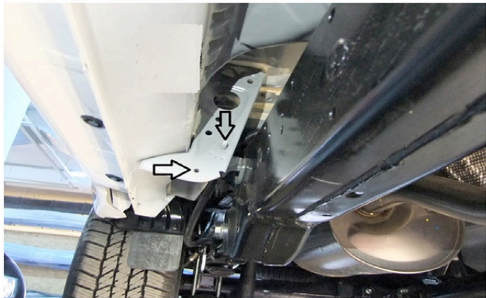
6) Hier sehen Sie die hinteren Halterungspunkte.
