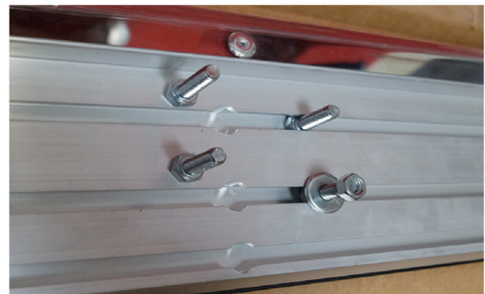
8) Fügen Sie nun unterhalb der Trittbretter die M8 Schrauben ein.
