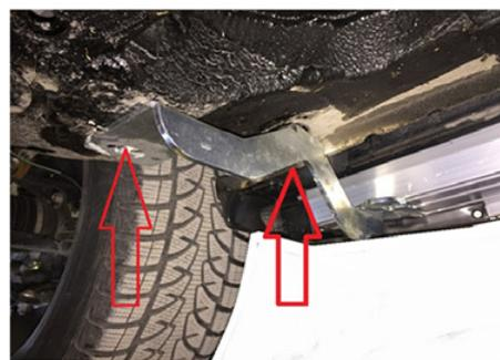
9) Bringen Sie auch vorne Unterhalb des Fahrzeugs die Halterungen an und verschrauben Sie diese.
