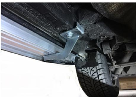
8) Bringen Sie als nächstes hinten am Fahrzeug die Halterung an und verschrauben Sie diese. (Das Trittbrett wird erst ganz am Ende auf die Halterungen gesetzt und nicht wie im Bild dargestellt)
