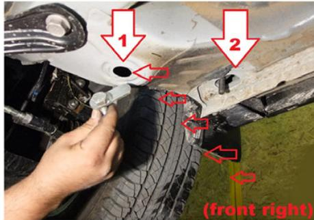
2) Nehmen Sie als nächstes vorne rechts unterhalb des Fahrzeugs die Kunststoffkappen ab und setzen Sie an den markierten Stellen die Spezialschraube ein.
