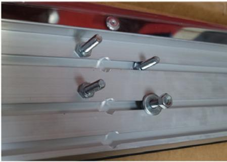
1) Bringen Sie als Erstes die M8 Schrauben unter die Trittbretter an. Die Unterlegscheibe und die Schraubenmutter bewahren Sie für den letzten Schritt auf.
