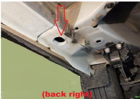
5) Im Bild wird hinten rechts unterhalb des Fahrzeugs der nächste Verschraubungspunkt dargestellt.
