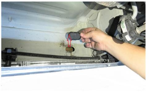
3) Bringen Sie nun die hinteren Halterungen an das Fahrzeug an. Als nächstes entfernen Sie die Plastikstopfen in der mitte.
