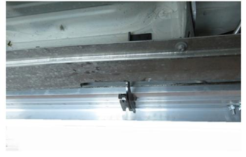
**5) Danach können Sie ganz einfach die Schraube mit der Halterung verbinden und festschrauben. Im Anschluss können Sie die Trittbretter auf den Halterungen platzieren.**
