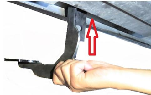
4) Platzieren Sie als nächstes die Schrauben wie im Bild dargestellt in die Löcher. Anschließend schieben Sie die Halterung wie im Bild dargestellt durch den Spalt.
