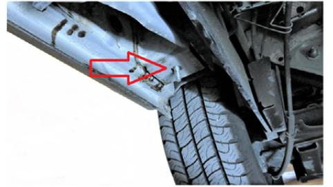
2) Bringen Sie als nächstes die vorderen Halterungen an und schrauben Sie diese fest. Als nächstes sehen Sie die hinteren Verschraubungspunkte am Fahrzeug, dort platzieren Sie dargestellte Schraube.
