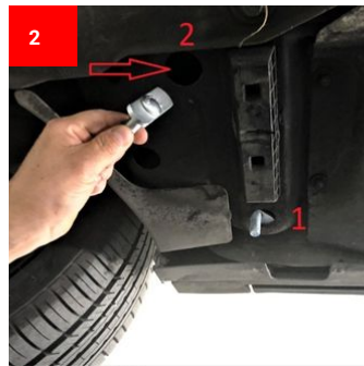
2 2 1 Setzen Sie die M12 L Schraube ein Insert the M12 L screw
