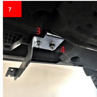
7 3 4 Befestigen Sie den Halter Attach the holder
