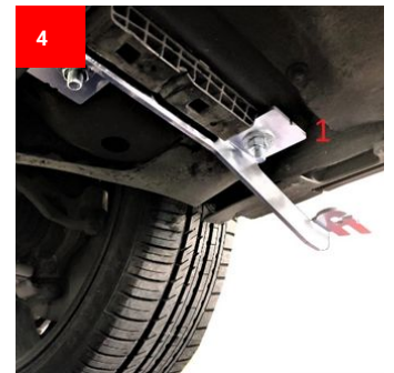
4 1 2 Befestigen Sie den Halter Attach the holder
