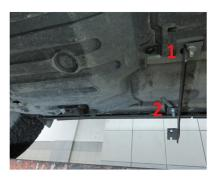
11) Montieren Sie nun die hinteren Halterungen an. (Hier im Bild hinten links)11) Now mount the rear brackets. (Here at the back left)
