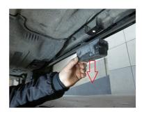
5) Nehmen Sie nun vor dem hinteren Rad das Plastikteil ab. Auf dem unteren Metalstück wird die Montage später fortgeführt.
