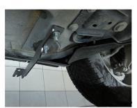
4) Montieren Sie als nächstes die vordere Halterung auf der linken & rechten Seite.4) Next, mount the front bracket on the left & right sides.
