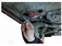
Setzen Sie als erstes die 12 mm Schrauben vorne unterhalb des Fahrzeugs ein.
