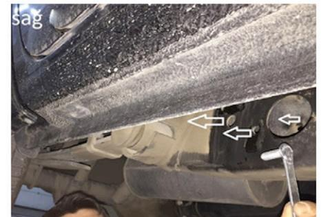
7) Hier sehen Sie die Verbindungspunkte hinten rechts am Fahrzeug.
