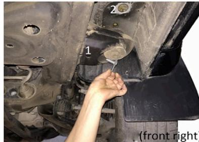
3) Setzen Sie an die mit der 1 gekennzeichneten Stelle die M10 Spezialschraube ein.
