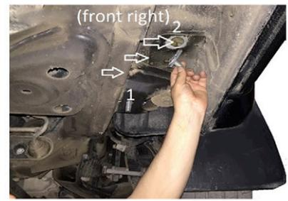
4) Setzen Sie auch eine M10 Spezialschraube an mit der 2 gekennzeichneten Stelle.
