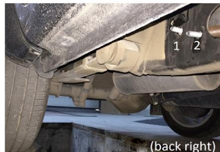
8) Setzen Sie die M10 Spezialschraube in L-Form in Platz 1. Setzen Sie M12 Spezialschraube in L-Form in Platz 2 ein.
