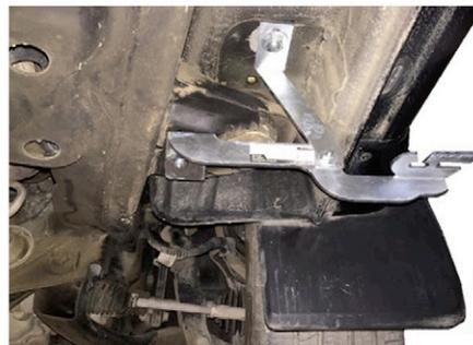
6) Setzen Sie zuerst die mittlere kürzere Halterung an die Stelle mit der die 2 markiert war und verschrauben Sie die mit den M8 Schrauben.
