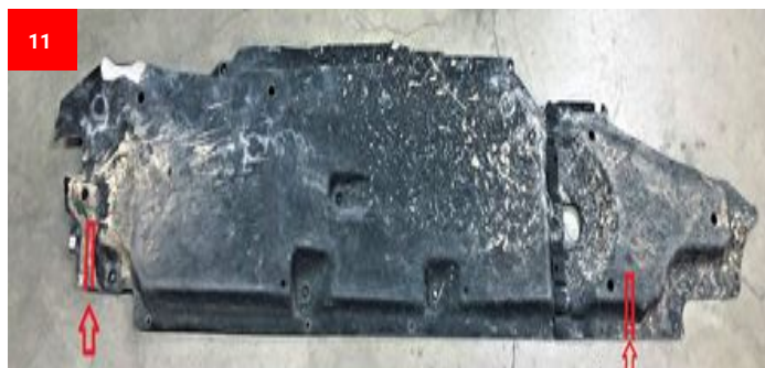
11 Schneiden Sie den Unterfahrerschutz an der Markierten stelle aus und Montieren diesen wieder Cut out the underrun protection at the marked point and reinstall it
