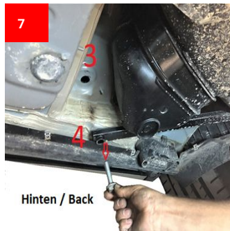
7 Entfernen Sie Schraube 4 und Setzen die M10 L Schraube ein (3) Remove screw 4 and insert the M10 L screw (3) Hinten / Back
