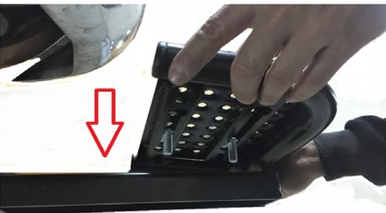
7) Anschließend können Sie die Trittplatte an der Halterung anbringen.
