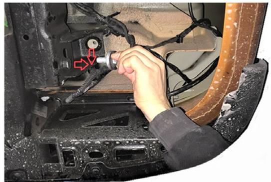
2) Die entfernten Schrauben müssen Sie wegen der späteren Verschraubung aufbewahren.
