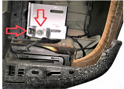
4) Befestigen Sie nun die Platte mit den zuvor entfernten Schrauben.
