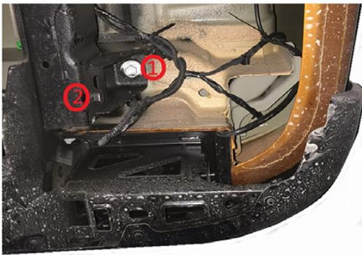
1) Die im Bild dargestellten Punkte 1 und 2 müssen unterhalb des Fahrzeugs (links) abgeschraubt werden.
