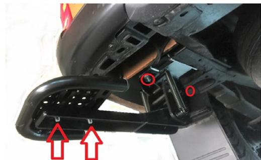
8) Als letztes richten Sie die Trittstufe ein und verschrauben die Spezialschrauben an den markierten Punkten.
