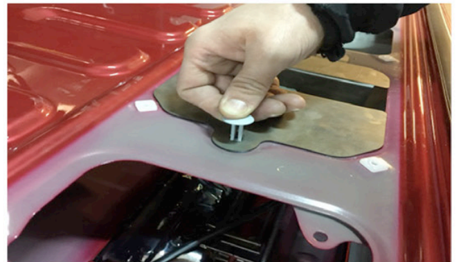
10) Befestigen sie den Stellmotor mit dem im Lieferumfang enthaltenen Befestigungen. 10) Fix the servomotor with the included fixings.
