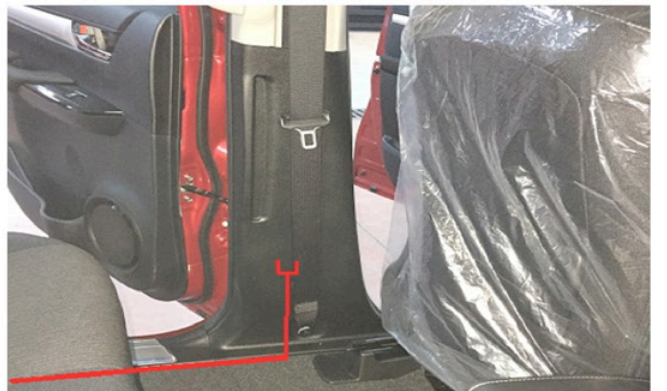
12) Entfernen Sie die Verkleidung der B-Säule Vorsichtig. Unter der Verkleidung, finden Sie die Anschlüsse der Zentralverriegelung an dem der Stellmotor Angeschlossen wird. 12) Remove the B-pillar cover gently. Under the cover, you will find the connections of the central locking system to which the servomotor is connected.
