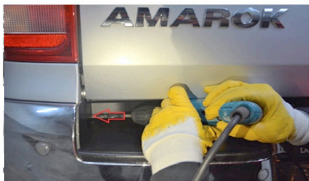
9) Um die Kabel lang zu ziehen machen Sie mit einem 5mm Bohrer an der linken Seite der Stoßstange (ist aus Kunststoff) ganz hinten an der Ecke eine Bohrung rein. To pull the cables long you make with 5 mm of drill on the left side of the bumper (a drilling is pure of plastic) completely behind on the corner.
