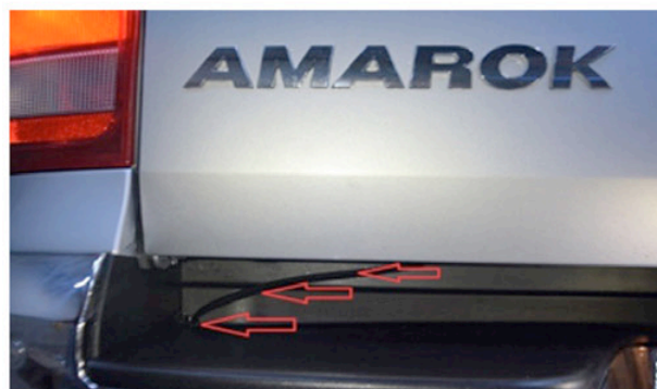
10) Ziehen Sie nun das Kabel bis nach unten durch. Pull now the cable down.
