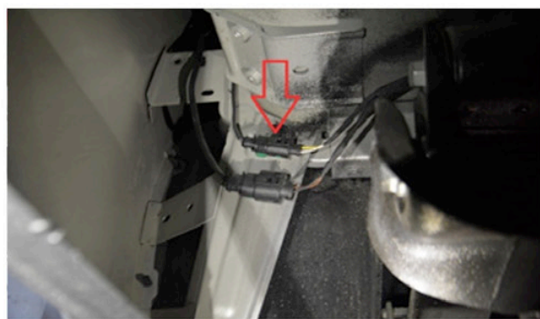
12) Diese beiden Kabel werden an der oberen Kabelbuchse verbunden. These two cables are connected to the upper cable connector.
